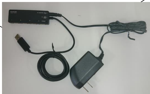
USBハブ(セルフパワー) ハブなしでも接続可能ですが、 電力不足が懸念されます
